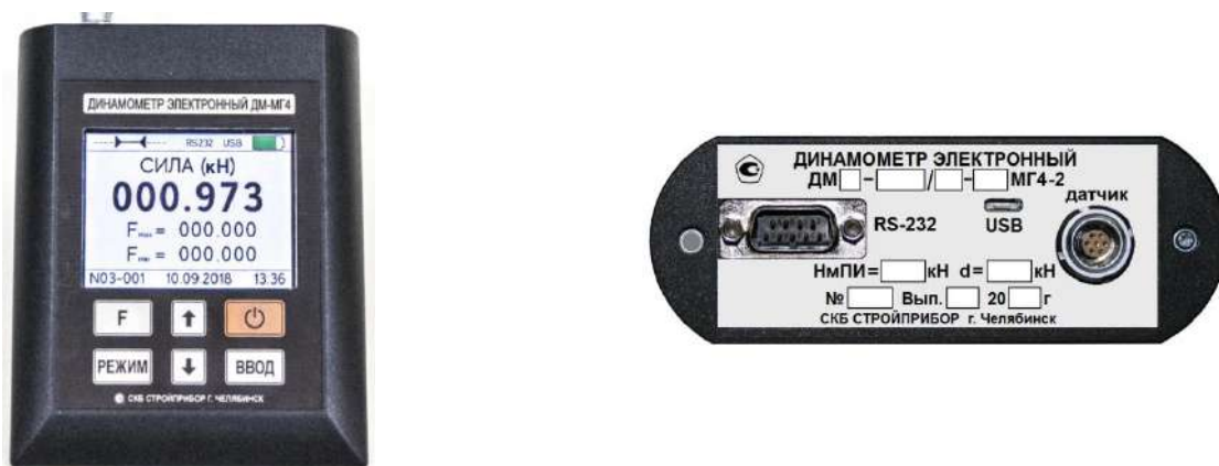
Рисунок 1.2 – Лицевая и верхняя панели электронного блока
